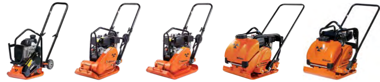
MVC-40H Plate size (w x l) 295 mm x 420 mm MVC-F60H Plate size (w x l) 350 mm x 510 mm MVC-F80H Plate size (w x l) 450 mm x 570 mm MVC-T90H Plate size (w x l) 500 mm x 525 mm MVC-T100D Plate size (w x l) 500 mm x 525 mm
